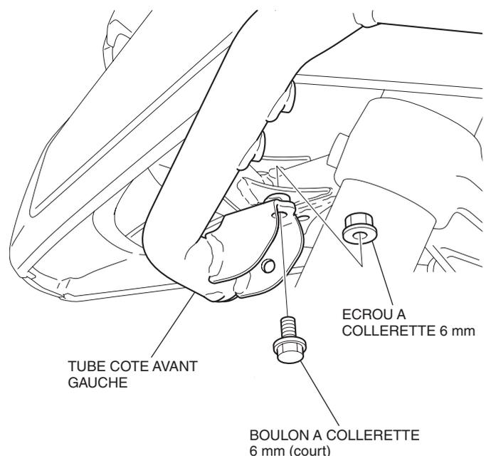
3. Posez le tuyau latéral avant droit et le support de tuyau latéral avant de la même manière que sur le côté gauche.
